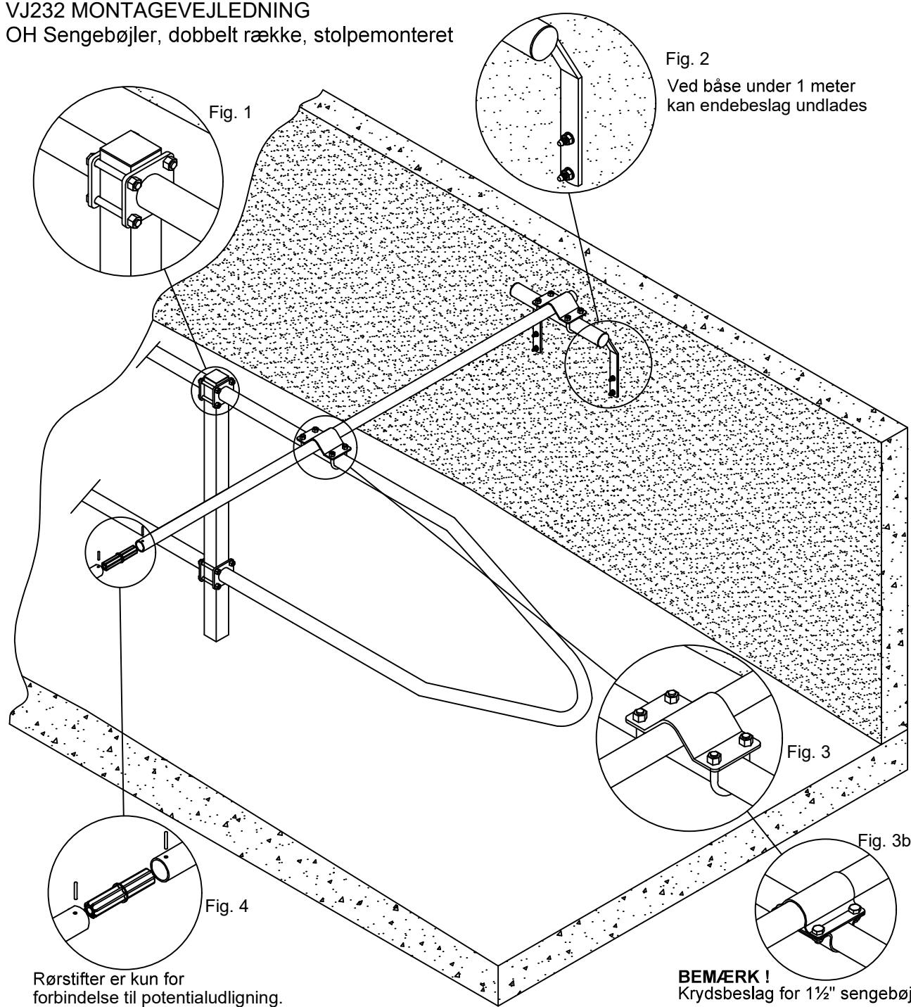
**Fig. 1** Monteres med: M12x110 maskinbolt og M12 låsemøtrik
