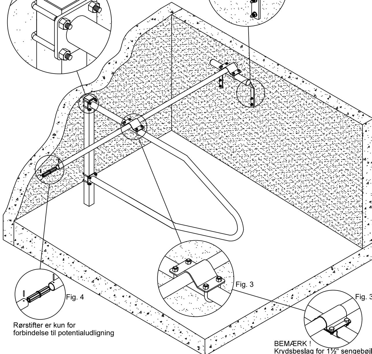
**Fig. 1** Monteres med: 12mm firkantbøjle 70 x 70 og M12 låsemøtrik
