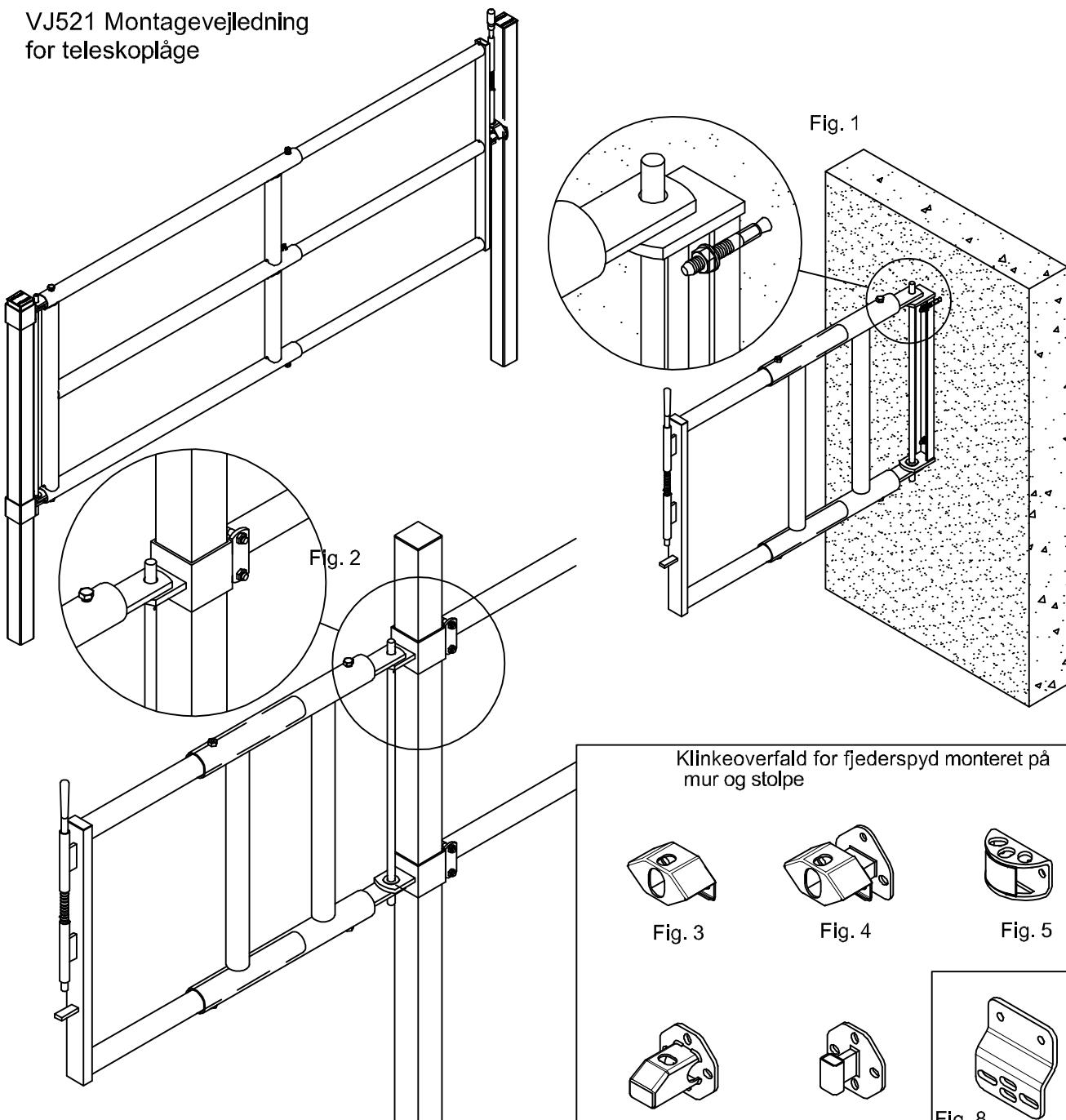
**Fig. 1** Vægbelag monteres med M10x80 Eksp. bolt
